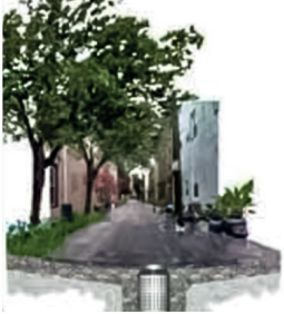
Depósitos de infiltración que actúan como zonas de embalse superficial donde se almacena el agua hasta que se produce la infiltración. Portland.
