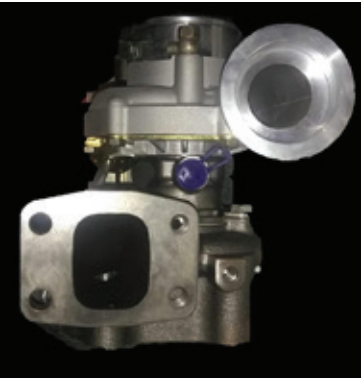
Figura 4 Vista frontal del turbocompresor Suotepower K16
