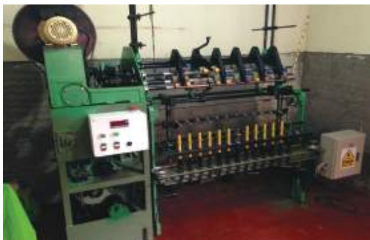
Figura 7. Máquina para hilar algodón nativo de color Elaboración propia
