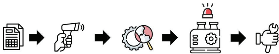
Figura 5 Activación de luz roja al detectar falla
